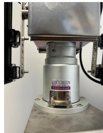
Korrekte Montage der Beleuchtungseinheit.
