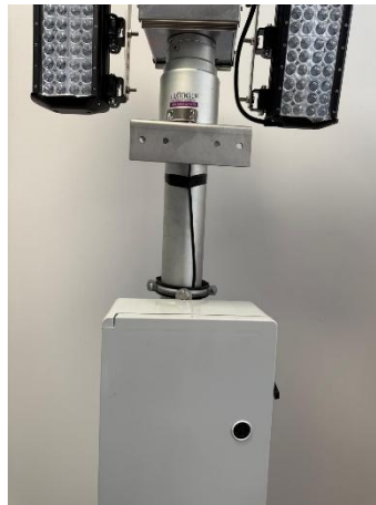
Korrekte Befestigung der Anschlussdose
