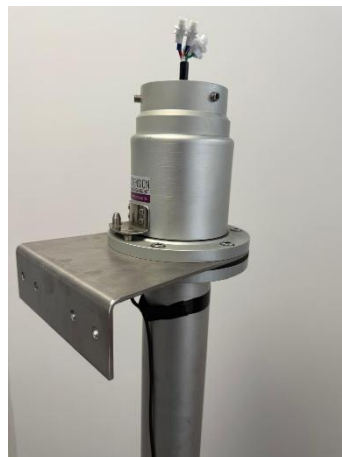
Korrekte Befestigung der Montageplatte
